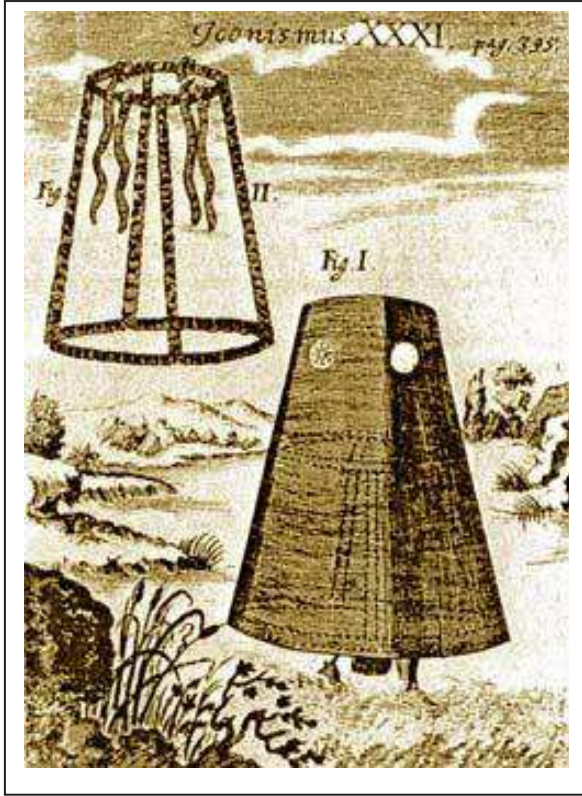
شكل 7: تصميم للقرن 17م يمثل حماية للغوص من جلد وحديد عن 1981 Pomey (P.), Gianfrotta (P.A.)
