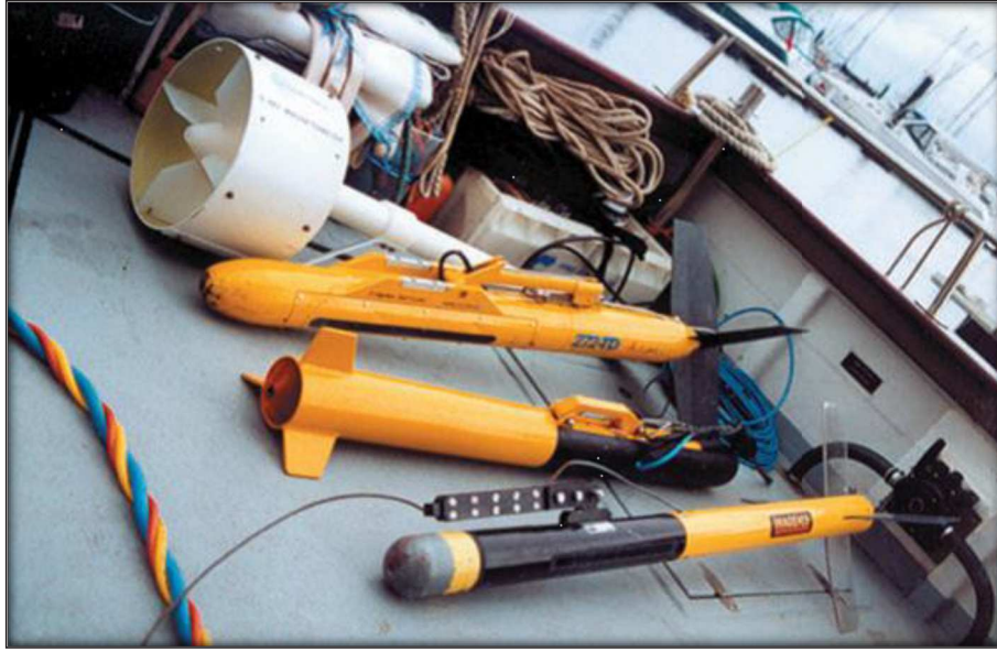
الصورة 11: مختلف الأجهزة الصوتية المستعملة في التحري تحت مائي عن Nautical Archaeology
